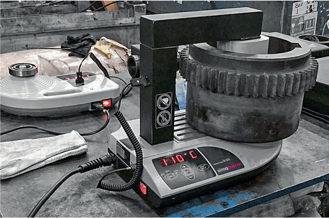
Die simatherm Geräte VOLCANO IH 025 und IH 070 mit zwei unterschiedlich grossen Anwärmteilen: Das Modell IH 070 (im Vordergrund) wärmt eine Zahnradhülse auf die vorgegebene Montage-temperatur an.
