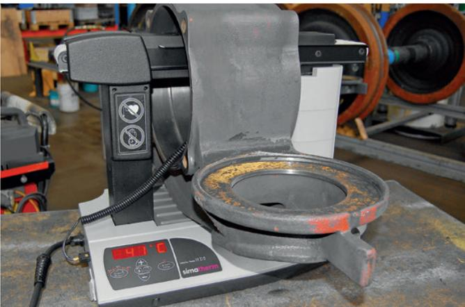
Für Arbeiten an einem Eisenbahnratsatz wird mit dem leistungsstarken Anwärmgerät IH 210 ein massives Lagergehäuse angewärmt.
