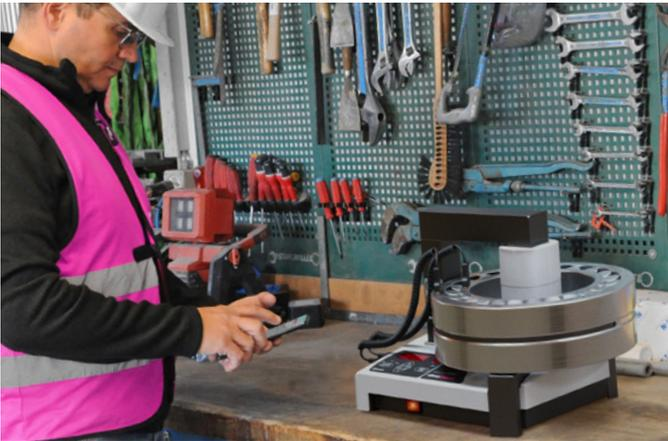
Via APP simatec WoM wird das simatherm IH 045 angesteuert. Dabei wird das Pendelrollenlager im Zwei-Sonden Modus erwärmt, um mechanische Spannungen im Lager zu vermeiden.
