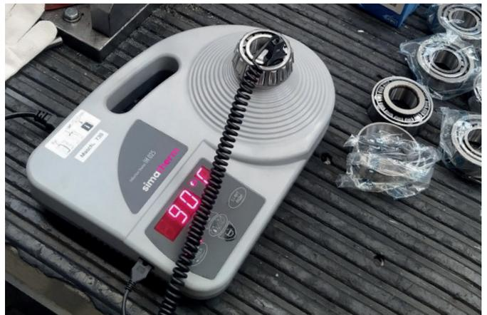
Das tragebare VOLCANO IH 025 im Einsatz für die Montage von Getriebewellen. Dazu wird mithilfe der Temperaturüberwachung ein Kegelrollenlager auf die gewünschte Temperatur erwärmt.
