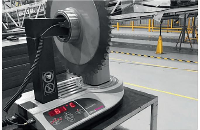
Das Anwärmgerät IH 070 leistet beim Anwärmen eines Umlenkritzels für die Stufenkette einer Fahrtrepppe wertvolle Dienste.
