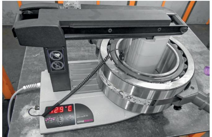
Mittels Induktion wird das auf der Spule liegende Pendelrollenlager mit dem simatherm Anwärmgerät IH 210 angewärmt. Ist die vorgegebene Montagetemperatur erreicht, wird das Lager mit dem simatool Bearing Handling Tool auf die Welle montiert.
