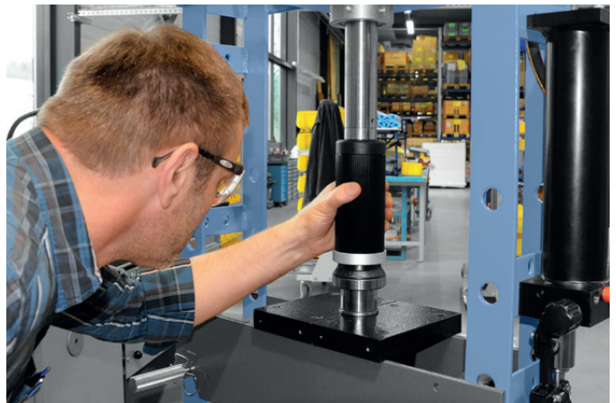
Das FT-P ist die ideale Lösung bei Montagen mit grösseren Einbaukräften, da das Werkzeug auf Pressen eingesetzt werden kann. Hochwertige Aluminiumringe, die sich auch bei Einpresskräften von 5 Tonnen nicht verformen.
