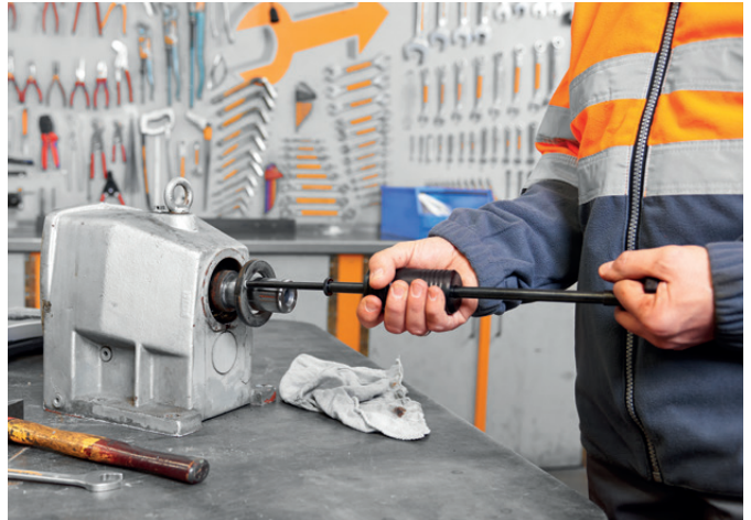
Gewusst wie: Ausbau einer Wellendichtung an einem Getriebe mit dem simatool Seal Puller SP 50.
