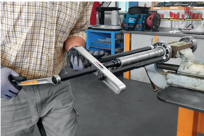
Der Ausbauwerkzeugsatz BP 160 ermöglicht mit Hilfe von Verlängerungen, auch schwer erreichbare Lager einfach und fachgerecht auszubauen.
