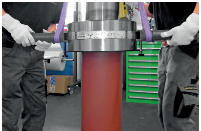
Das vorgewärmte schwere Pendelrollenlager lässt sich mit dem Bearing Handling Tool BHT sicher heben und kontrolliert auf die Turbinenwelle montieren.
