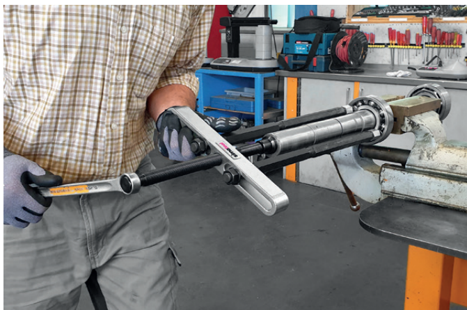
借助延长杆, BP 160 拆卸套装也能轻松、专业地拆卸难以触及的轴承。
