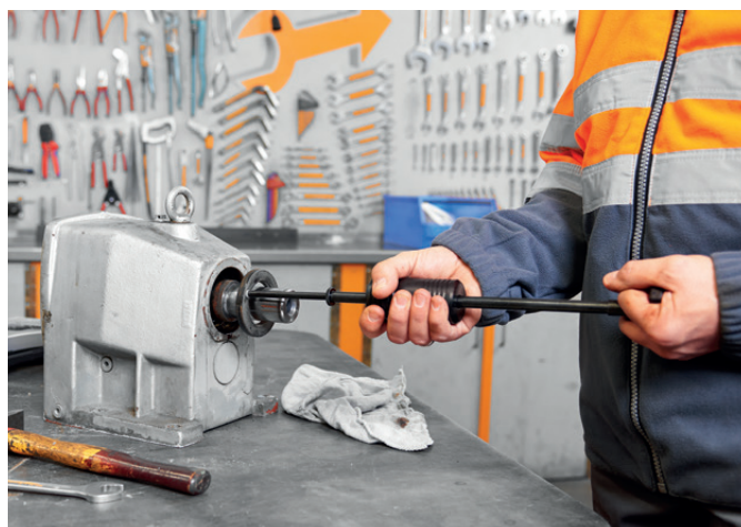
实用技巧: 使用密封圈拉马 SP 50 从齿轮箱上拆卸径向密封件, 不会损坏箱体或轴。
