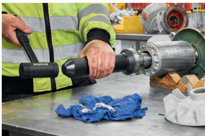
安装工具 FT 33 组套可确保安装力均匀作用于轴承内圈和外圈, 不会对滚动体产生额外应力。
