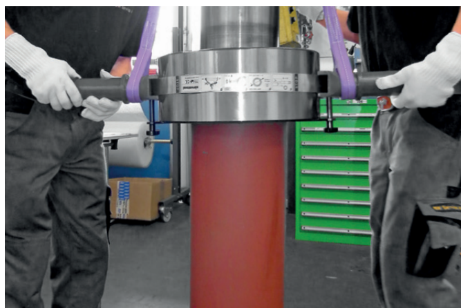
轴承搬运工具 BHT 可安全吊起经预热的重型滚动轴承, 并精准将其装配至涡轮轴上。
