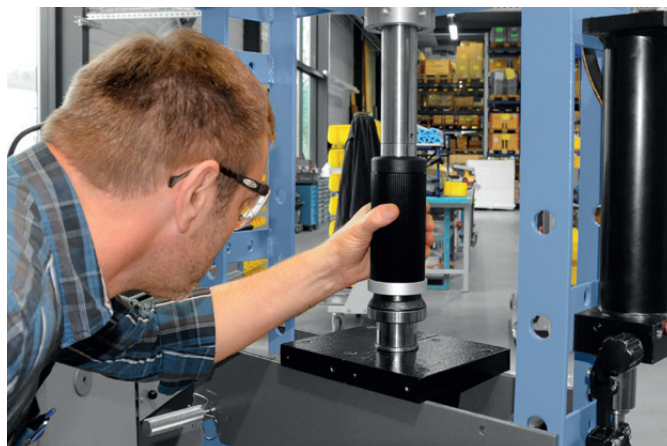
FT-P 是大载荷安装的理想方案, 可配合压力机使用。其配备的高品质铝合金环, 即便在 5 吨压紧力下也不会发生变形。
