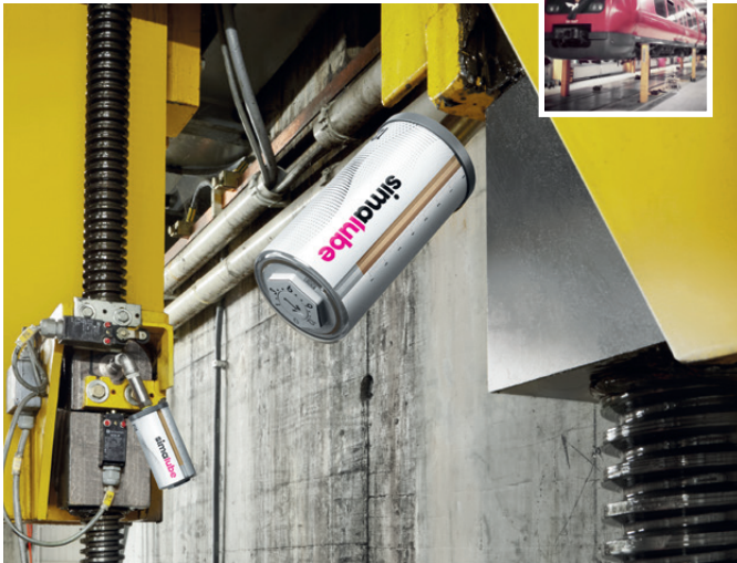
铁路机车提升站的丝杠使用125ml润滑器
