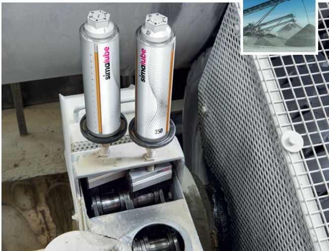
2个250ml森玛太克自动润滑器和毛刷用来清洁和润滑驱动链条
