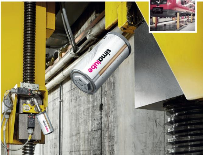
Los husillos de un sistema de elevación para vagones y locomotoras se lubrican con simalube 125 ml durante de 12 meses.
