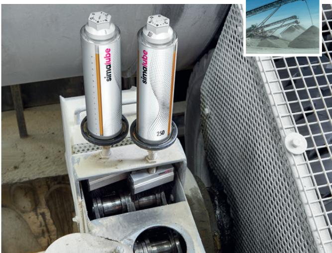
La cadena de transmisión de una lavadora de tambor se limpia y se lubrica con 2 lubricadores simalube de 250 ml con cepillos.
