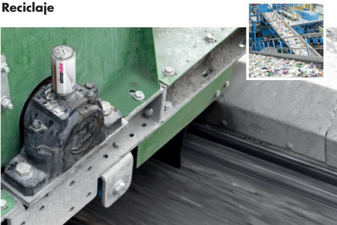
Un simalube de 125 ml lubrica el rodamiento de una cinta transportadora.
