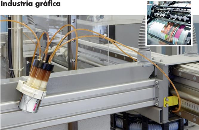
Un simalube multipunto lubrica 5 guías lineales en una cortadora y una apiladora de papel de una imprenta.
