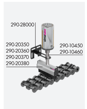
Kettenschmierung mit universell verstellbarem Support
