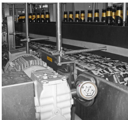
Lubrificação de uma correia de transporte com lubrificador simalube.
