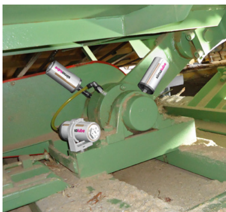
I cuscinetti di un vibratore sono lubrificati regolarmente con tre lubrificatori.
