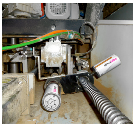
Il mandrino di una sega circolare viene lubrificato con 2 simalube 125 ml.
