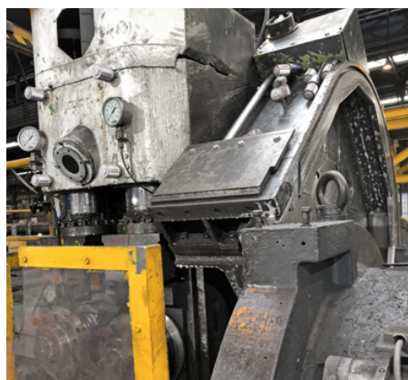
Vari lubrificatori simalube e IMPULSE lubrificano le colonne (a sinistra) e il motore (a destra) della roditrice.
