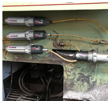
Il potenziatore di pressione simalube IMPULSE consente di installare i punti di lubrificazione a distanza sul bobinatore (cuscinetto, bussola guida e dentatura), nonché di procedere alla lubrificazione tramite un sistema di manicotti.
