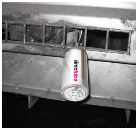
Il simalube lubrifica cuscinetti su un nastro trasportatore.
