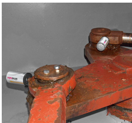
Lo sterzo è lubrificato con due lubrificatori 125 ml.
