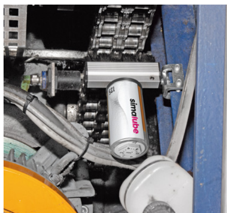
Il simalube lubrifica con olio le catene in maniera continua anche in spazi ristretti. La spazzola simultaneamente pulisce la catena.
