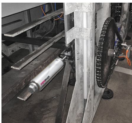
Lubrificazione catene con un simalube da 250ml e spazzola piatta.
