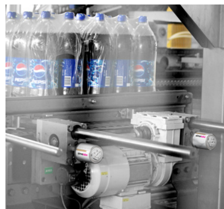
Il cuscinetto sulla scatola del cambio è lubrificato con due lubrificatori simalube 60 ml.
