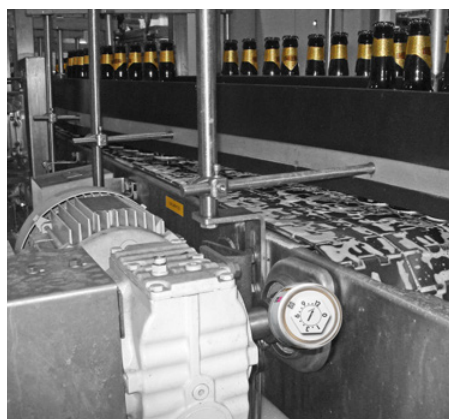
Lubrificazione di un nastro di trasporto con un lubrificatore simalube.
