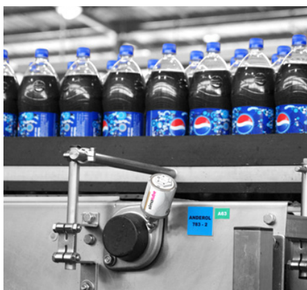
Lubrificazione di un cuscinetto su una macchina di riempimento per bibite.
