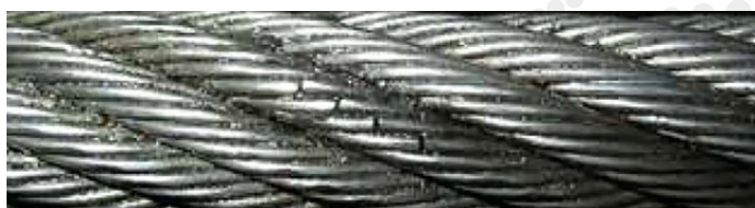
Rupture de fils
