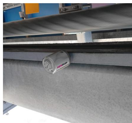
Avec le graisseur simalube, les galets de roulement peuvent être lubrifiés automatiquement et très facilement en continu.
