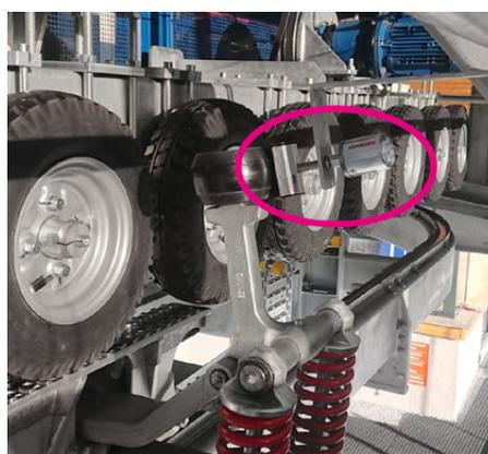
Un simalube de 60 ml applique un fin film lubrifiant sur les rouleaux d'accouplement via une brosse, ce qui permet de réduire leur usure et d'éliminer les bruits de circulation.
