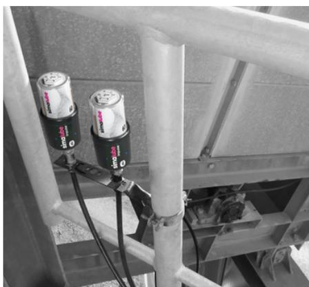
Les points de graissage se trouvent à une hauteur dangereuse. Grâce à l'application simatec, il est possible de les contrôler aisément depuis le sol.
