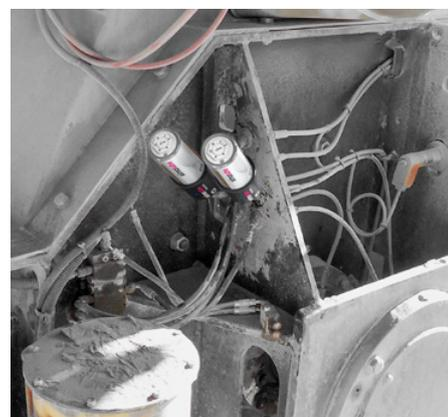
Dans une carrière, deux amplificateurs de pression simalube IMPULSE connect surmontent sans effort la contre-pression de deux paliers. En outre, ils ont été intégrés dans le plan de lubrification simalube «Lubechart» via l'appli simatec.
