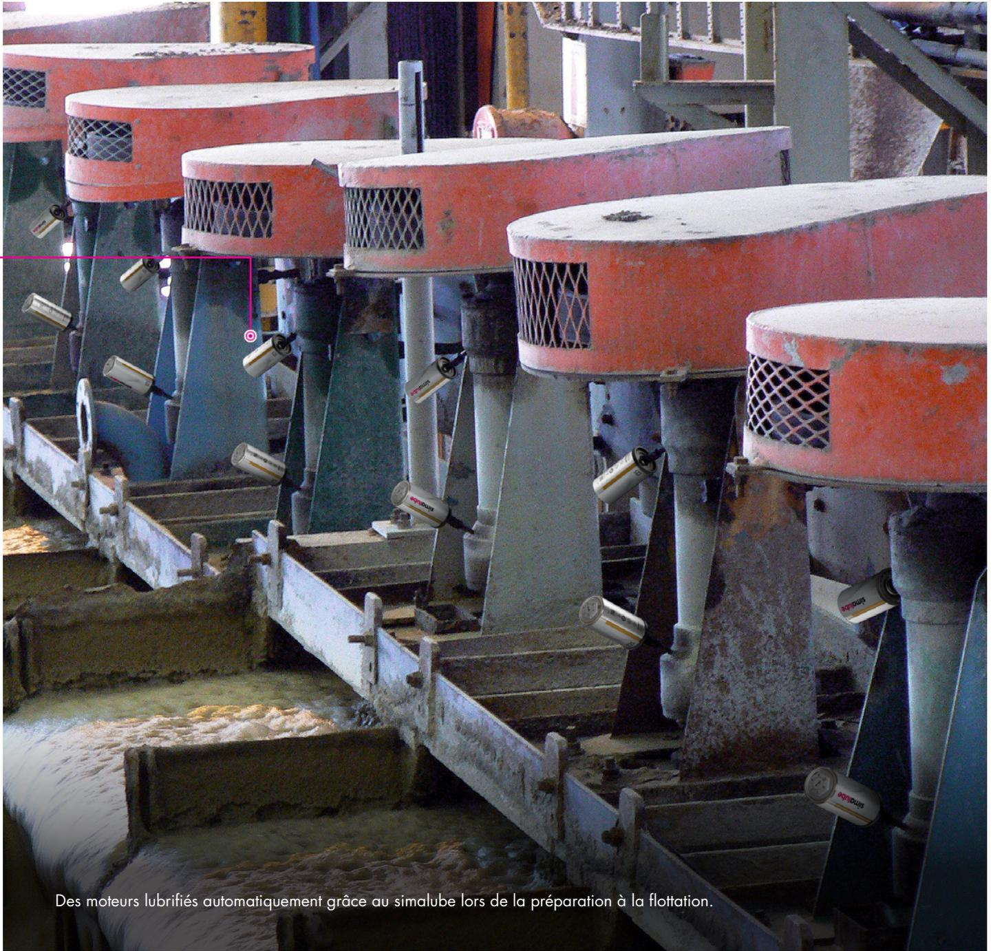
Des moteurs lubrifiés automatiquement grâce au simalube lors de la préparation à la flottation.
