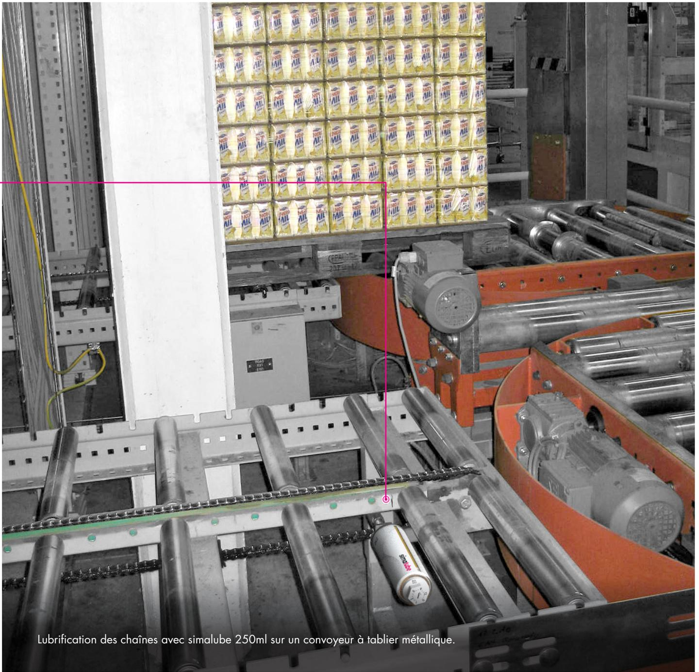
Lubrification des chaînes avec simalube 250ml sur un convoyeur à tablier métallique.
