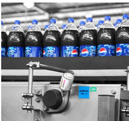
Lubrification d'un palier à bride pour une ligne de remplissage de boissons non alcoolisées.
