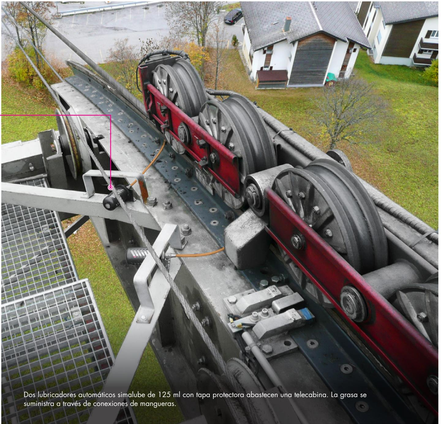
Dos lubricadores automáticos simalube de 125 ml con tapa protectora abastecen una telecabina. La grasa se suministra a través de conexiones de mangueras.
