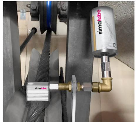
El cable del teleférico se lubrica con un lubricador automático simalube. Con los cepillos se aplica el lubricante y se limpia el cable.
