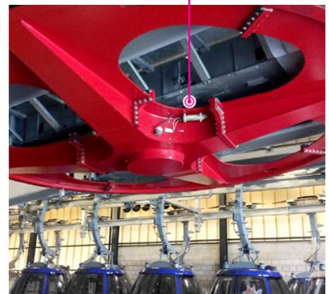
En la estación base se lubrican las poleas de inversión de una telecabina con dos lubricadores automáticos simalube de 250 ml.
