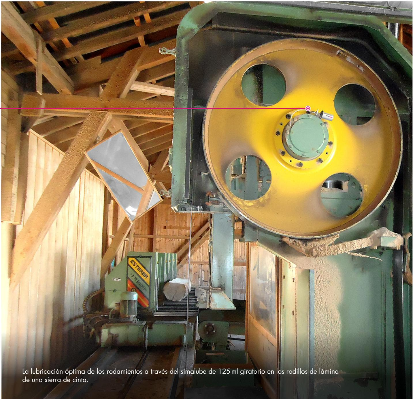
La lubricación óptima de los rodamientos a través del simalube de 125 ml giratorio en los rodillos de lámina de una sierra de cinta.
