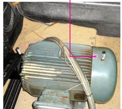
En una fábrica maderera se lubrica el electromotor del accionamiento del peine descargador.
