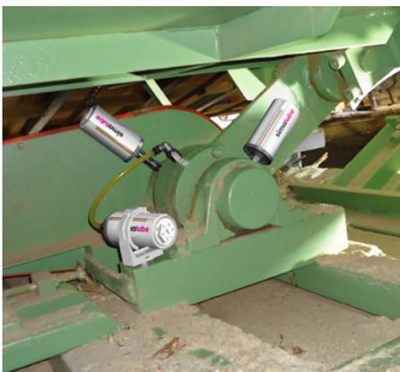
Tres lubricadores abastecen los cojinetes del canal vibratorio de forma continua con lubricante.
