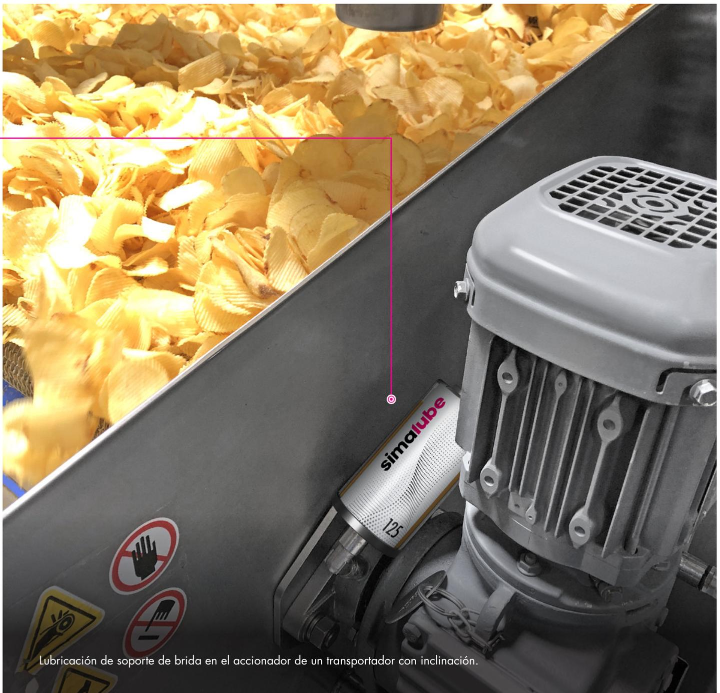
Lubricación de soporte de brida en el accionador de un transportador con inclinación.
