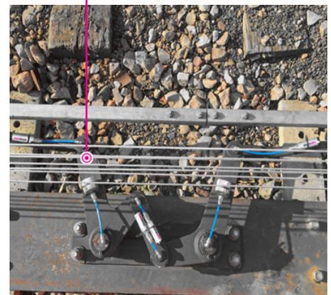
Dos simalube de 30 ml y cuatro simalube de 15 ml lubrican continuamente el compensador de un sistema de señalización.
