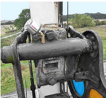
El rodamiento de una señal ferroviaria se lubrica automáticamente y continuamente a través de un lubricador simalube de 30 ml.
