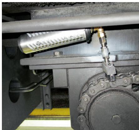
El lubricador simalube de 250 ml abastece la cadena de transmisión de una grúa de rieles. Una tapa protectora protege el dispensador.
