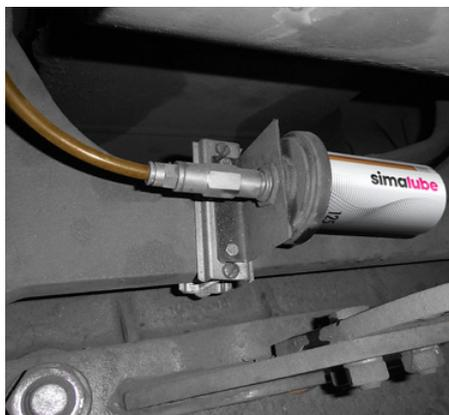
El dispensador de 125 ml se instala en el chasis de un tranvía de piso bajo. El lubricante se conduce al punto de lubricación a través de una manguera.
