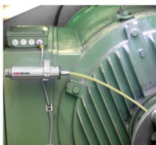
Con el simalube de 250 ml se abastece el generador continuamente de lubricante hasta 12 meses como máximo.
