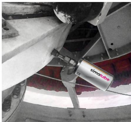
Bei dieser Windkraftanlage ist der *simalube* Schmierstoffgeber mit einer Spendezeit von sechs Monaten eingestellt.
